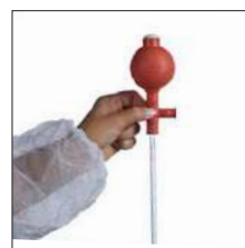
4. Inflar la pera presionando el punto intermedio C.
