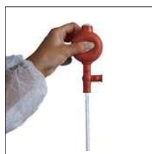
1. Evacuar el aire presionando la pera como indica el dibujo.
