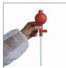
2. Aspirar presionando el punto B ↑
