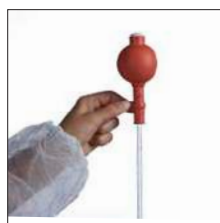
3. Expulsar el líquido presionando el punto A ↓
