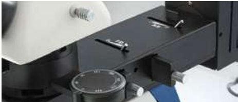
Lente de Bertrand, deslizamiento λ, analizador giratoria (360°) (extraíble)
